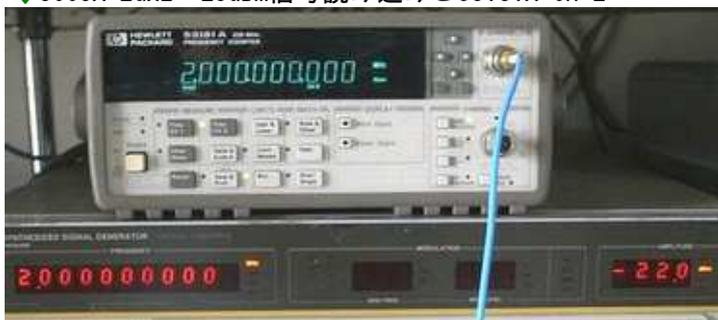
↓ 8642B 2.1GHz -22dBm信号読み込み@53131A Ch-3
